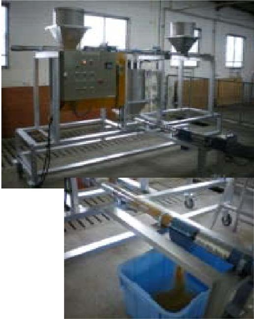
飼料米と配合飼料の混合給与装置試作機
