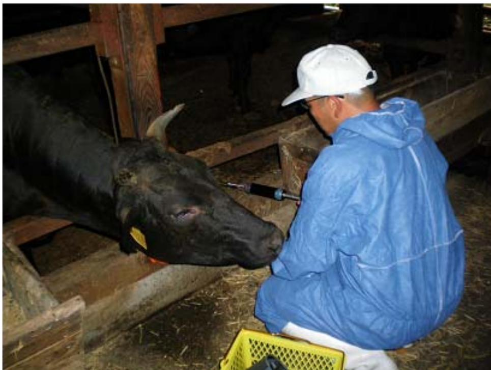
ガス検知管で牛舎内のアンモニア濃度を測定
