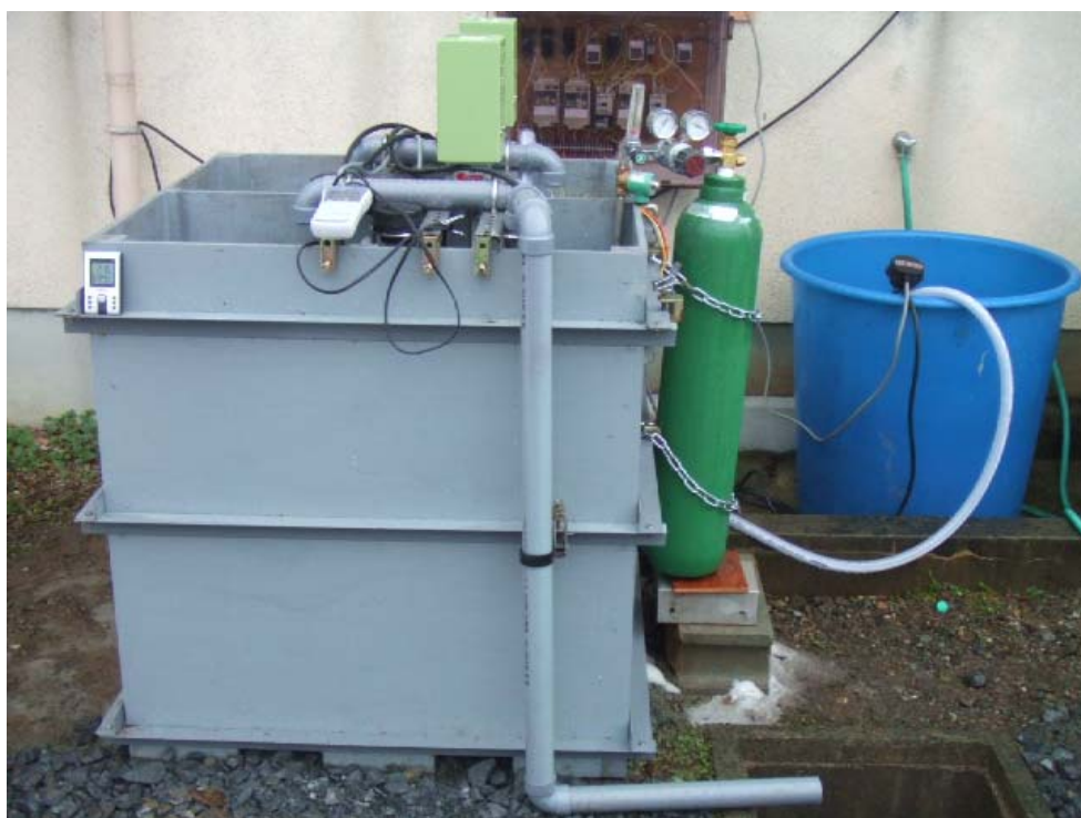
鳥インフルエンザウイルス不活化装置のパイロットプラント（実験装置）
