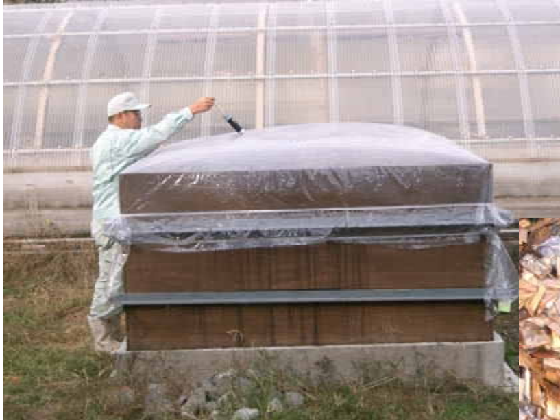
樹木チップを用いた脱臭装置
