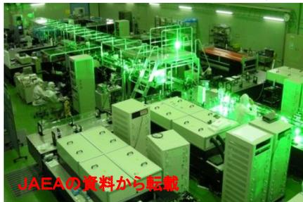
レーザープラズマを利用することで、従来のマイクロ波を用いるよりもけた違いに強い加速電界を作ることが可能となる。
